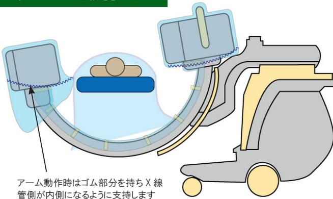
アーム動作時はゴム部分を持ちX線管側が内側になるように支持します
